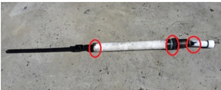
Rys. 2. Uszkodzony izolator przepustowy z demontażu po 2 latach eksploatacji w elektrodehydratorze.
