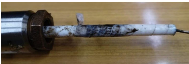
Rys. 12. Uszkodzony rdzeń izolatora
