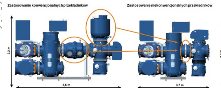
Rys. 3. Porównanie gabarytów pola rozdzielnic Blue GIS 8VN1 przy zastosowaniu konwencjonal- nych i niekonwencjonalnych przekładników
