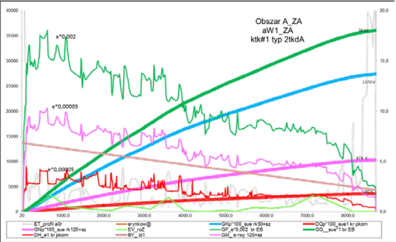
Rys. 3. Jednostkowe e i sumaryczne sue zmiany SEM indukowanego [V] w metalowych żyłach kabla telekomunikacyjnego typu ALTKDpxFtx w różnych warunkach redukcyjnych, podczas przepływu w LK110 1-fazowego prądu zwarciego o wartości początkowej 13,7 kA. Kolor czerwony dotyczy zmian SEM do projektu końcowego.
